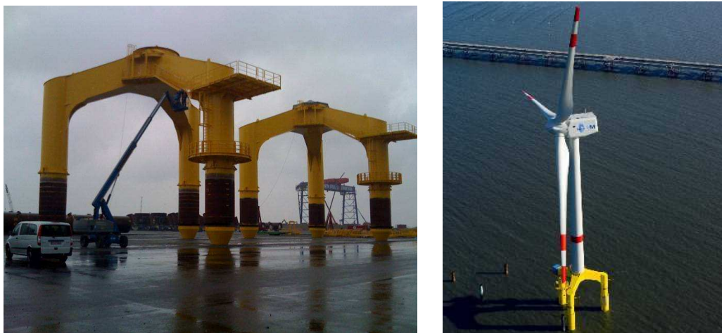
Fig. 24 – Fondazioni tripalo installate nel parco eolico Hooksiel (Germania).
