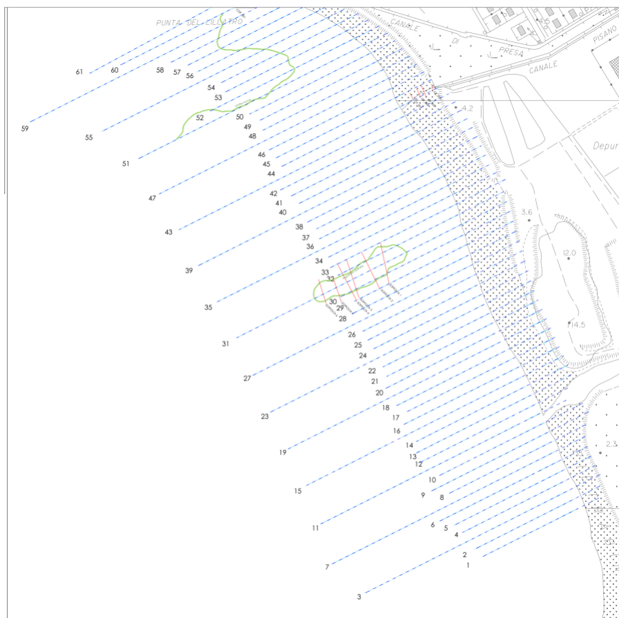
Figura 19: Linee di progetto di un rilievo Single-Beam
