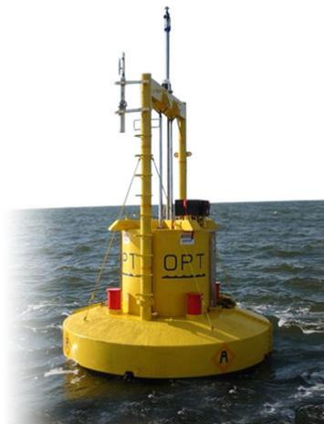
Fig. 3.8. Prototipo OPT de Santoña, dispositivo absorbedor puntual. [Ocean Power Technologies, www.oceanpowertechologies 2004]
