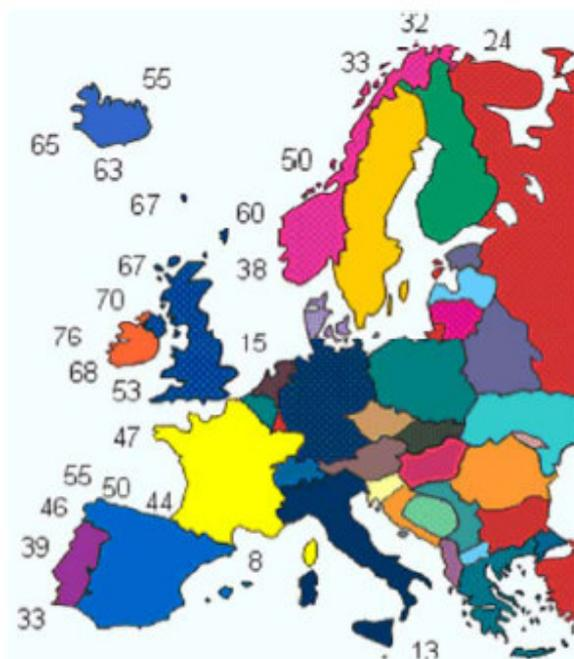
Fig. 2.5. Distribución europea de la potencia anual de las olas en kW/m. [CRES [www.cres.gr/kape/index\\_eng](http://www.cres.gr/kape/index_eng), 2004]
