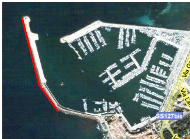
Fig. 8.1. Esquema del emplazamiento del SSG sobre el rompeolas. [maps.google.it]
