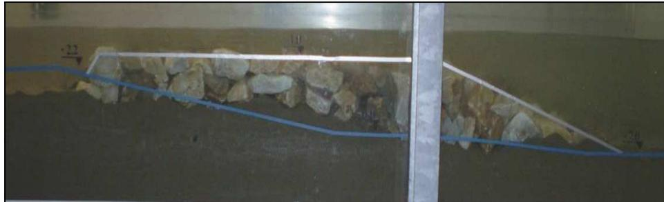
Foto 5.5 - Scogliera sommersa ricostruita in canale per la configurazione C3.
