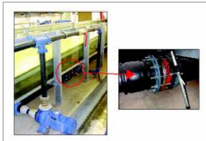
Foto 3.4 - Particolari del sistema di ricircolo: pompa di aspirazione e valvola di chiusura.
