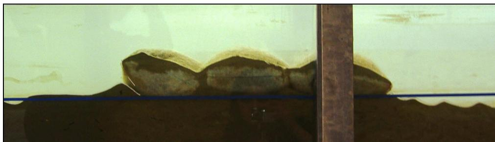
Foto 5.6 - Barriera in geocontenitori ricostruita in canale per la configurazione C4.
