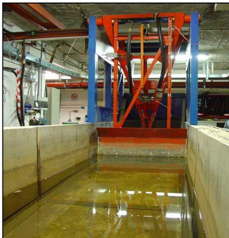
Foto 3.2 - Prospetto frontale della parte meccanica del generatore di onde del laboratorio di Idraulica.
