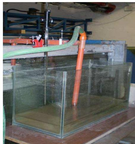
Foto 5.1 - Componenti dell'apparato per la misura dei volumi di overtopping.
