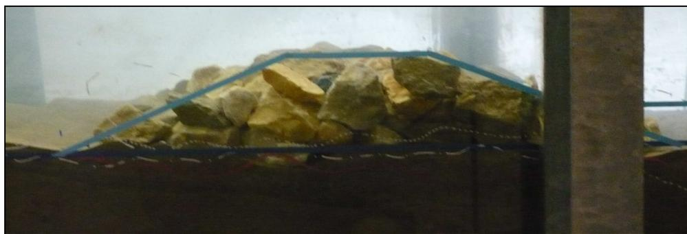
Foto 5.9 - Scogliera in massi ricostruita in canale per la configurazione C9.
