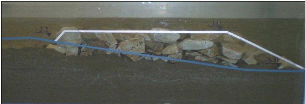
Foto 5.4 - Scogliera sommersa ricostruita in canale per la configurazione C2.
