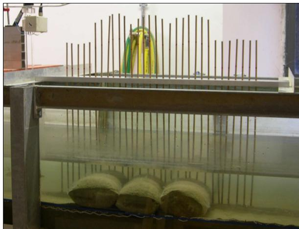
Foto 6.1 – Rilievi effettuati tramite il rilevatore a barre sulla struttura in geotubi
