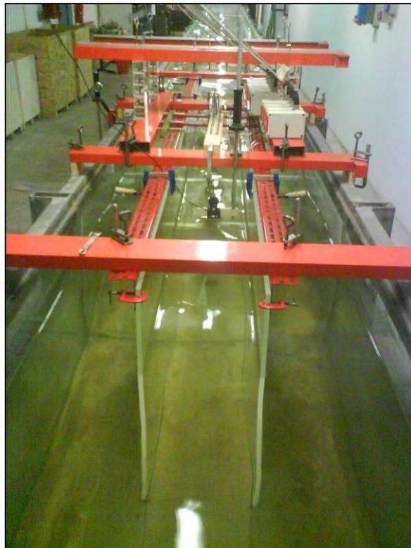
**Figura 24** – Parzializzazione del canale in tre sotto canali.
