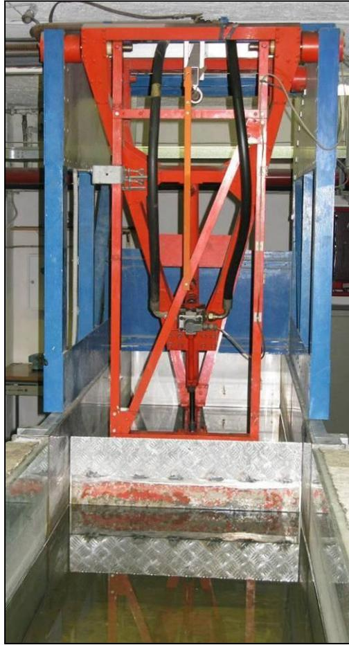
**Figura 20** - Prospetto frontale della parte meccanica del generatore del moto ondoso.
