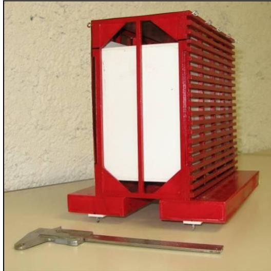
**Figura 34** – Modello del frangiflutti da testare nella III fase sperimentale.
